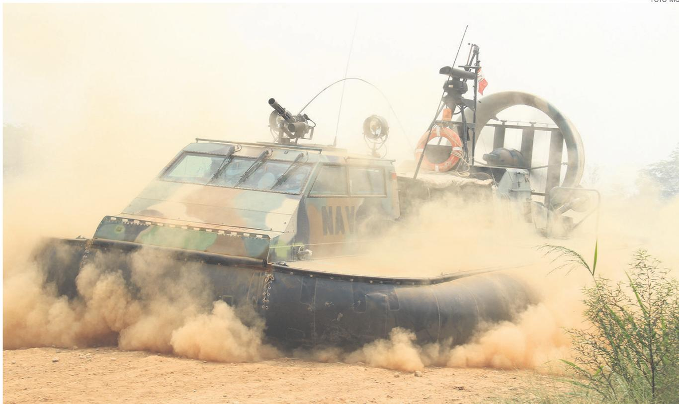
Los Hovercraft Griffon 2000TD vienen siendo mejorados con blindaje adicional y montajes para ametralladoras Dillon Aero M134D.
